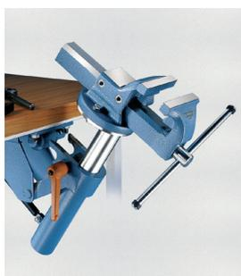
Bei Nichtgebrauch wird der Schraubstock nach Lösen des rechten Sicherheitsspannhebel unter die Werkbank abgesenkt.
